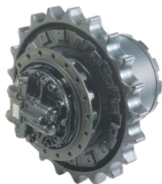
Ремонт редукторов хода
