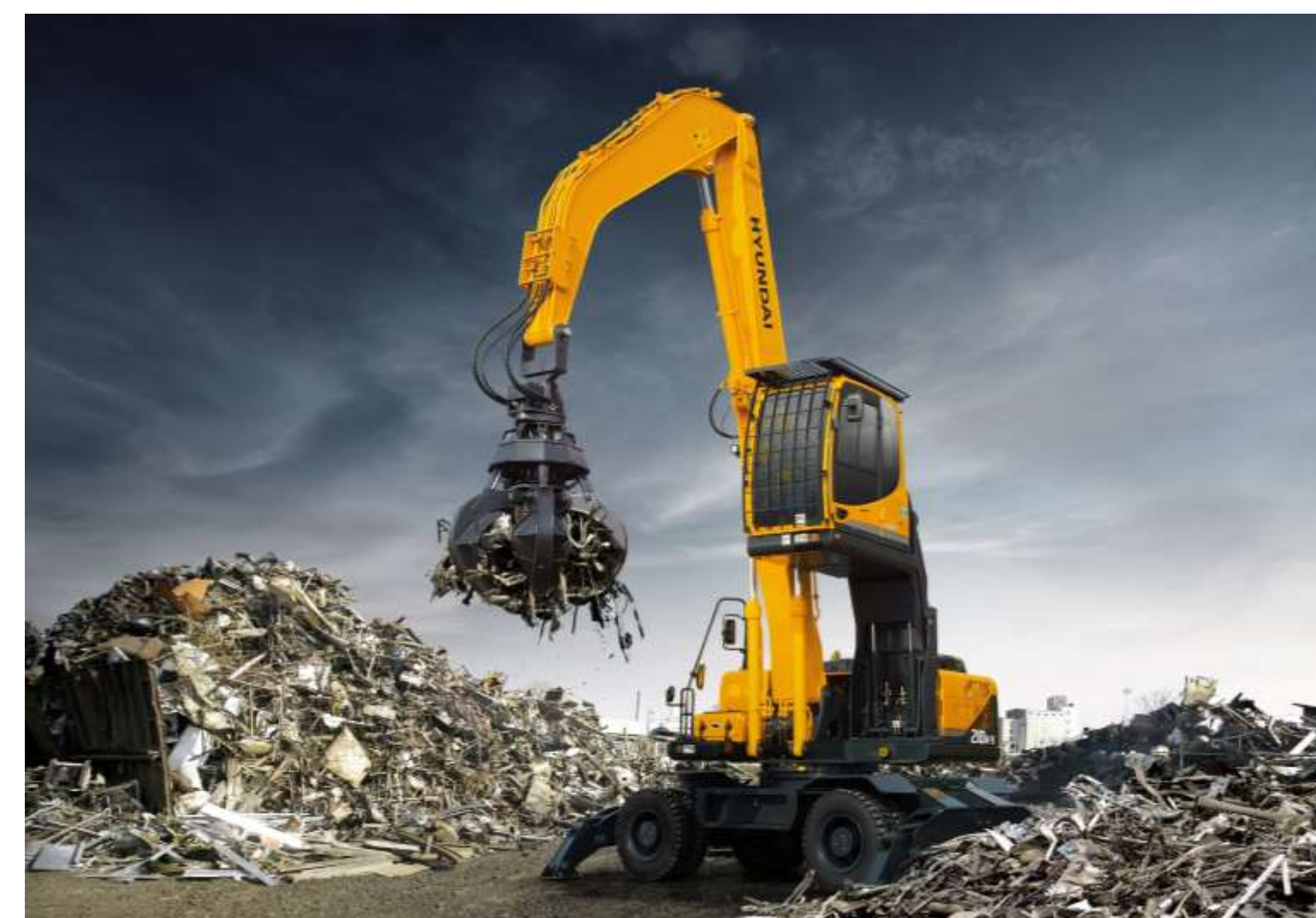
Экскаватор с телескопическим грейферным оборудованием
